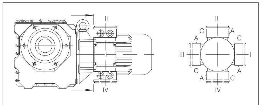
如图所示，可依据 DIN 42950 规定，在不同的位置安装接线盒，图示详细说明接线盒的位置和电缆进入的方向。
