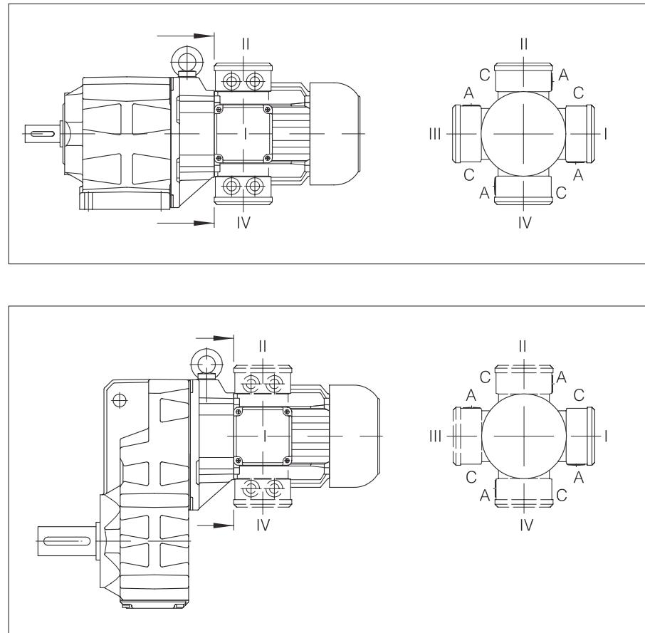
如图所示，可依据 DIN 42950 规定，在不同的位置安装接线盒，图示详细说明接线盒的位置和电缆进入的方向。
